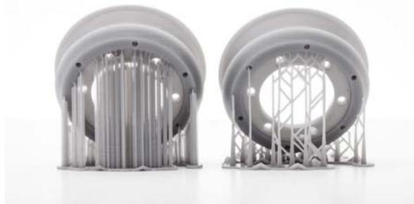
Рис. 1. 3D-печатные SLA-детали с опорными конструкциями
