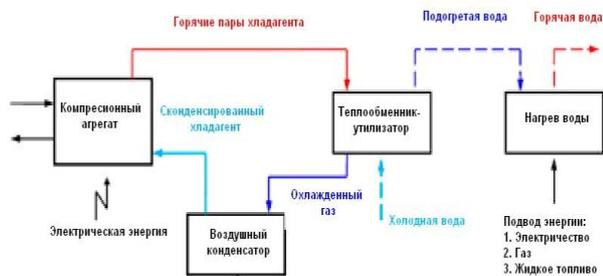
Рис. 1. Комбинированная схема ГВС или отопления
